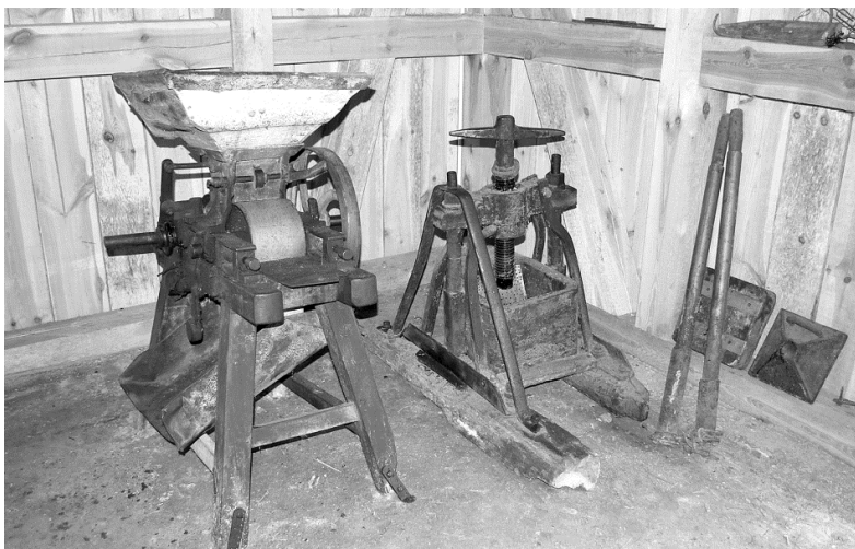
Ryc. 2. Urządzenia technologiczne olejarni: młynnik walcowy i prasa typu śrubowego. Stan po renowacji na ekspozycji w „Łęczyckiej Zagrodzie Chłopskiej”. Fot. P. Czepas
