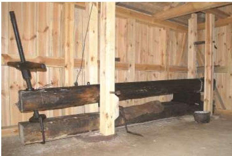
Ryc. 2b. Urządzenia technologiczne olejarni po renowacji i translokacji do „Łęczyckiej Zagrody Chłopskiej” w Kwiatkówku pod Łęczycą. Prasa typu dźwigniowego. (fot. P. Czepas)
