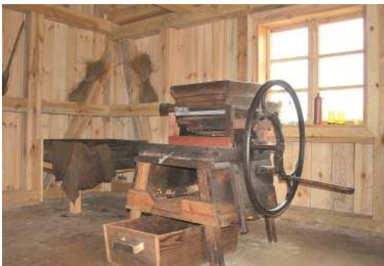
Ryc. 3. Urządzenia technologiczne olejarni po renowacji i translokacji do „Łęczyckiej Zagrody Chłopskiej” w Kwiatkówku pod Łęczycą. Mlewnik walcowy typu gniołącego, w tle skrzynia na śrutę. (fot. P. Czepas)
