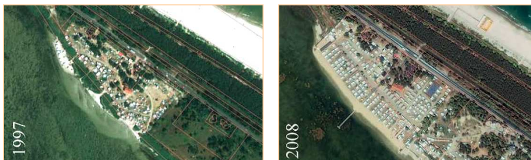
Fot. 6. Powiększenie powierzchni kempingu Solar w Chałupach poprzez dosypywanie plaży
