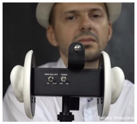
**Ryc. 2.** Mikrofon binauralny z nakładkami w kształcie ucha<sup>26</sup>. Źródło: opracowanie własne.
