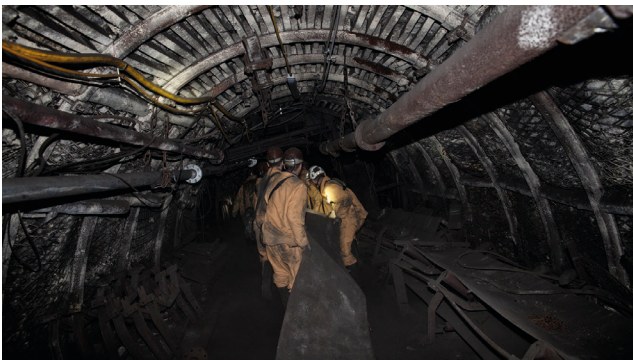
Fotografia 2. Przeniesienie elementu taśmociągu w czasie górniczej szychty Źródło: Szychta – tymczasowo wstrzymana (2020)
