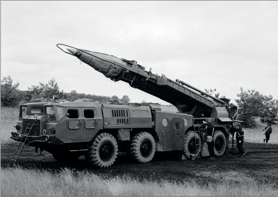
3. Zestaw raketowy 9K72 Elbrus w trakcie zajmowania położenia startowego na poligonie w Orzyszu (Źródło: Muzeum Artylerii w Toruniu, Oddział Muzeum Wojsk Lądowych w Bydgoszczy)
