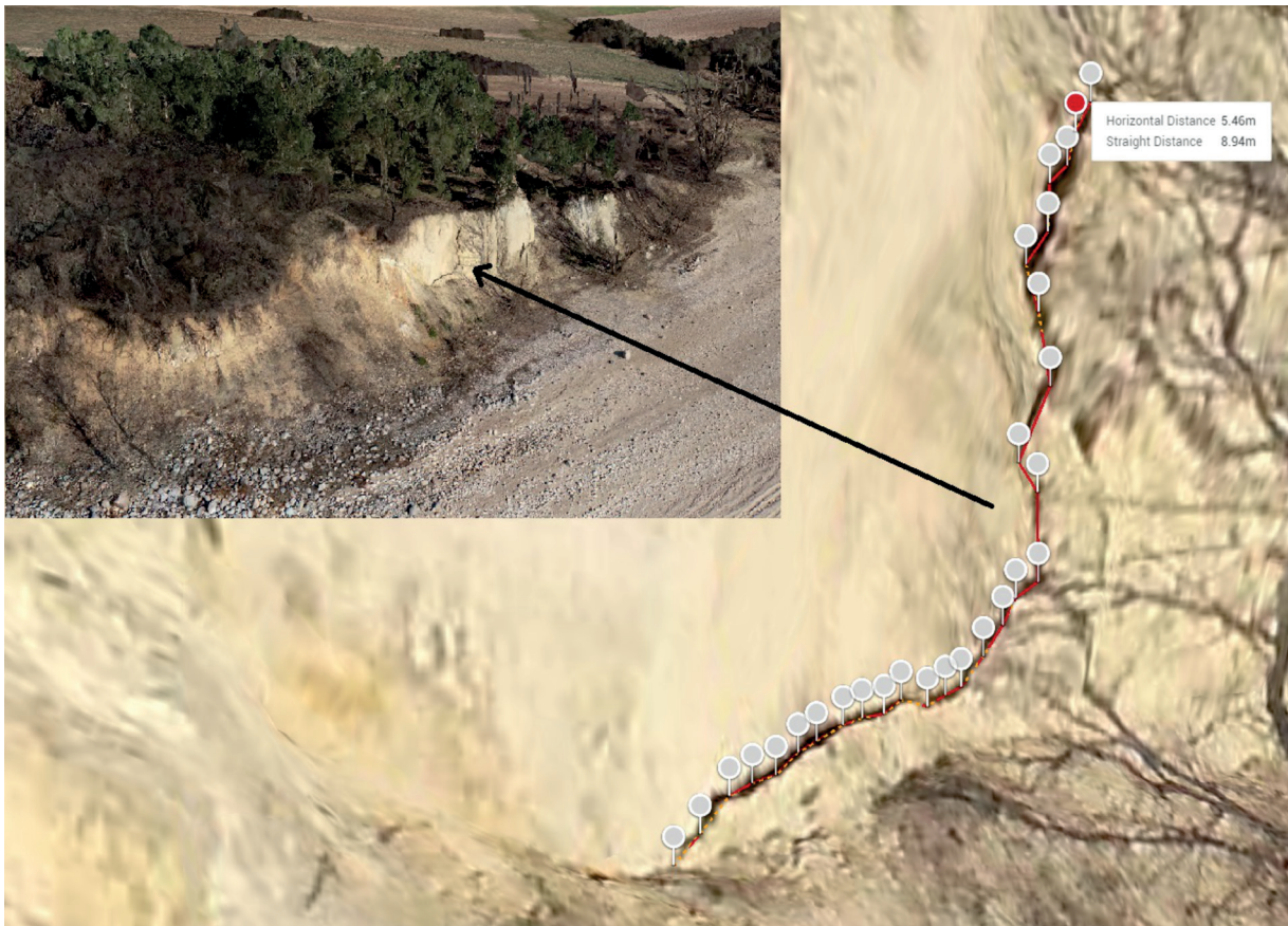
Rys. 4. Fragment modelu klifu z widocznym pęknięciem oraz pomiar jego długości i wysokości Fig. 4. Fragment of the cliff model with a broken surface visible
