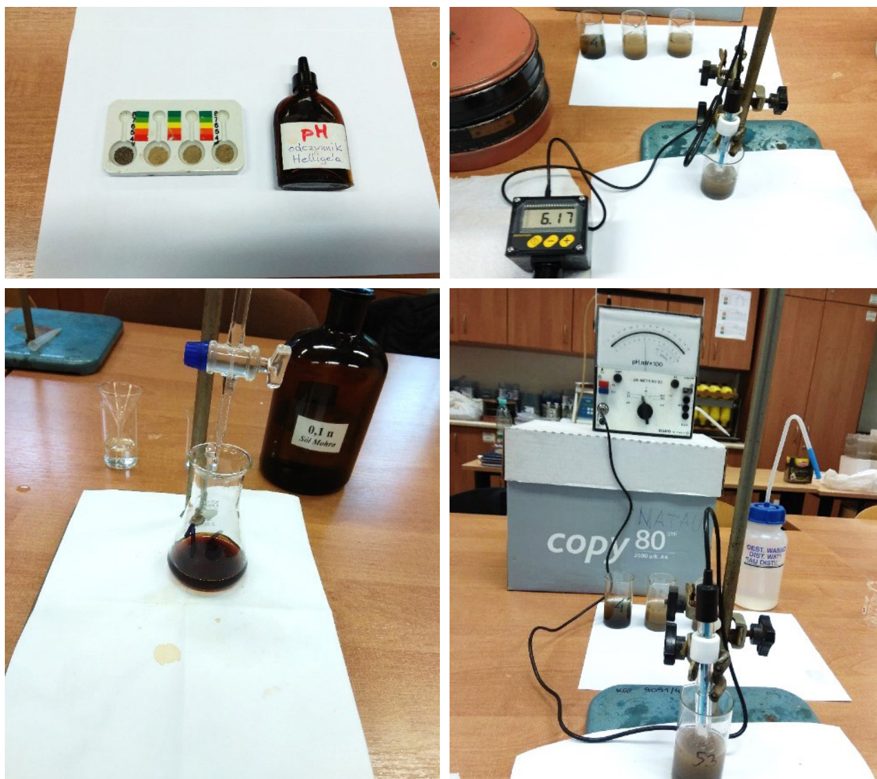
Rys. 5. Oznaczanie odczynu gleb i zawartości węgla organicznego Fig. 5. Determination of soil reaction and organic carbon content
