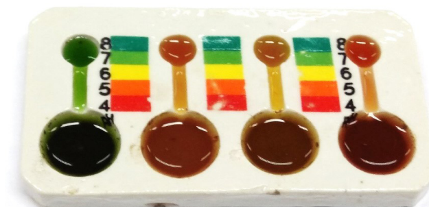
Fot. 3. Wyniki wstępnego pomiaru odczynu metodą kolorymetryczną
