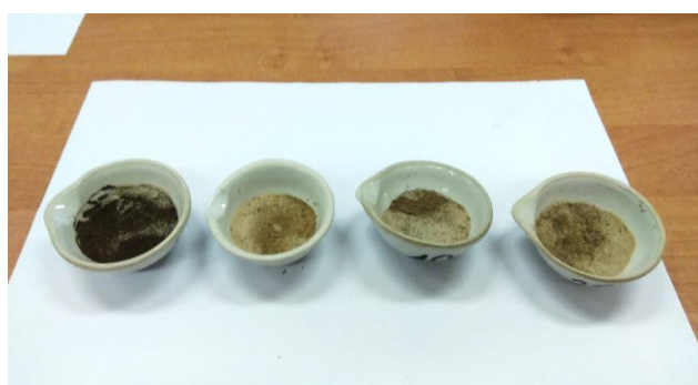
Rys. 4. Suszenie gleb nr 1–4 i oznaczanie składu granulometrycznego
