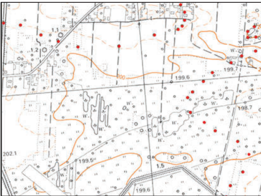
Rys. 2. Przebieg wektoryzowanej poziomiczycy 200 m n.p.m. z mapy w skali 1:25 000 (oznaczono kropkami) na tle mapy w skali 1:10 000 (Arkusz 132.411 Wola Grzymalina)
