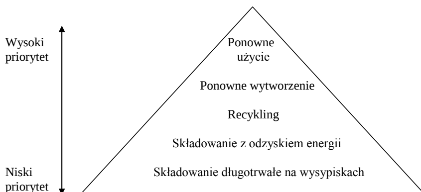
Rys. 2. Hierarchia postępowania z odpadami wg koncepcji zrównoważonego rozwoju
