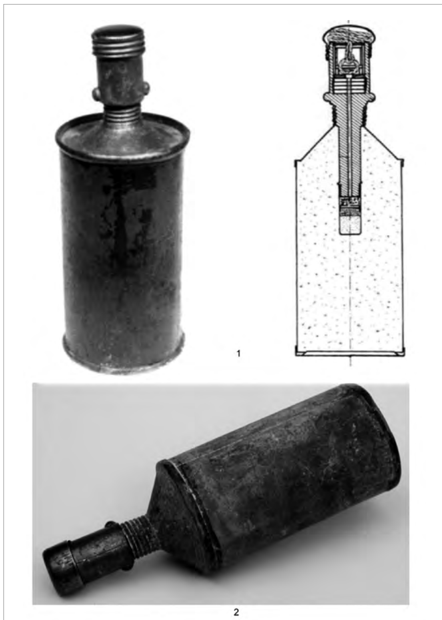
Ryc. 2. 1 – granat R-42 z zapalnikiem P-42. Widoczny przekrój granatu i zapalnika (źródło: http://www.dws-xip.pl/pw/bron/pw77.html [Iv 2018]); 2 – granat R-42 z zapalnikiem P-42 z późniejszego okresu produkcji (źródło: http://www.muzeumwp.pl/dictionary/granat-sidolowka,471,duzy.jpg [Iv 2018]).
