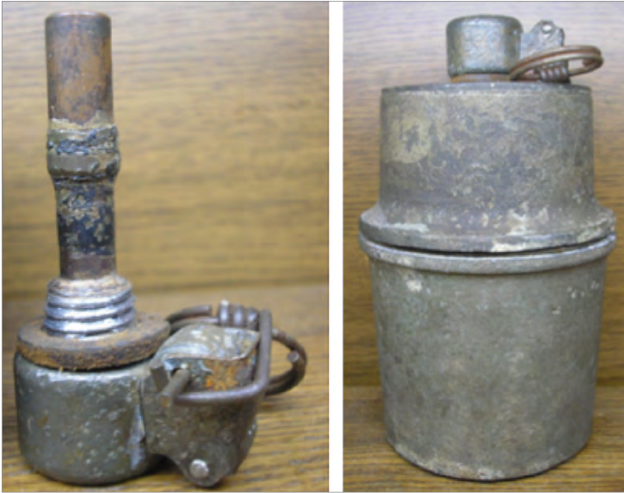
Ryc. 4. Zapalnik wz. GR 31 po przeróbce (obcięta dźwignia zabezpieczająca) oraz granat „Karbidówka” po zmontowaniu (źródło: archiwum autora).
