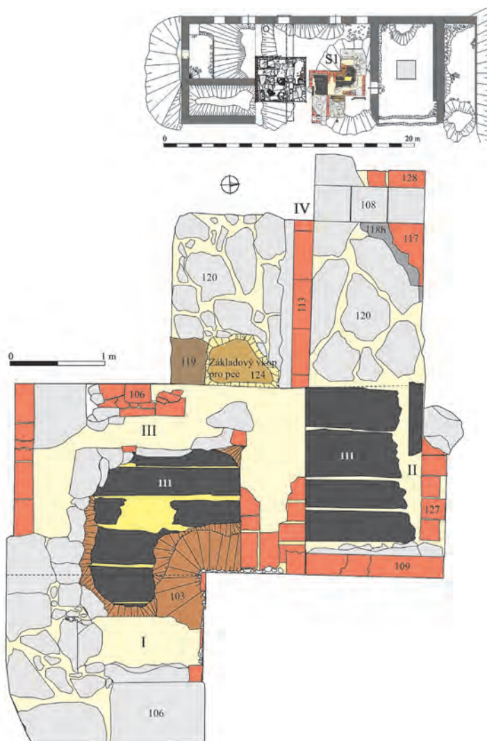
Obr. 7. Mašův mlýn (okres Tachov). Sonda 1, sektor I, II, III a IV. Plán zachycuje dlažby v sektoru II a IV (SJ 120, SJ 127) a spálenou dřevěnou podlahu v sektoru III a II (SJ 111). V sektoru III je patrný relikv chlebové pece (K106). Na plánu je zachycena též dlažba (SJ 108) a práh (SJ 128), které však náležejí do nejmladší stavební fáze objektu. V horní části obrázku je sondáž zasazena do kontextu vodního mlýna. Datace: průběh 19. století až počátek 20. století, kdy objekt zanikl požárem (digitalizace L. Galusová).
